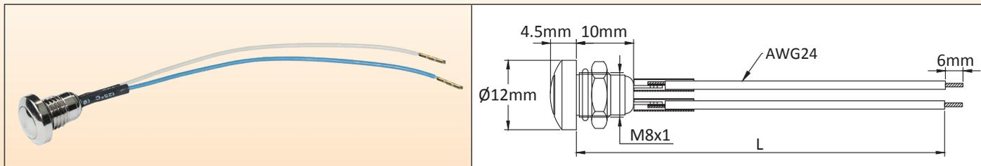
Verdrahteter Schalter für manuelle Rückstellung. Benötigt ein Ø8mm Loch in der Montageplatte. Drahtlänge 100mm. Andere Längen auf Anfrage.
