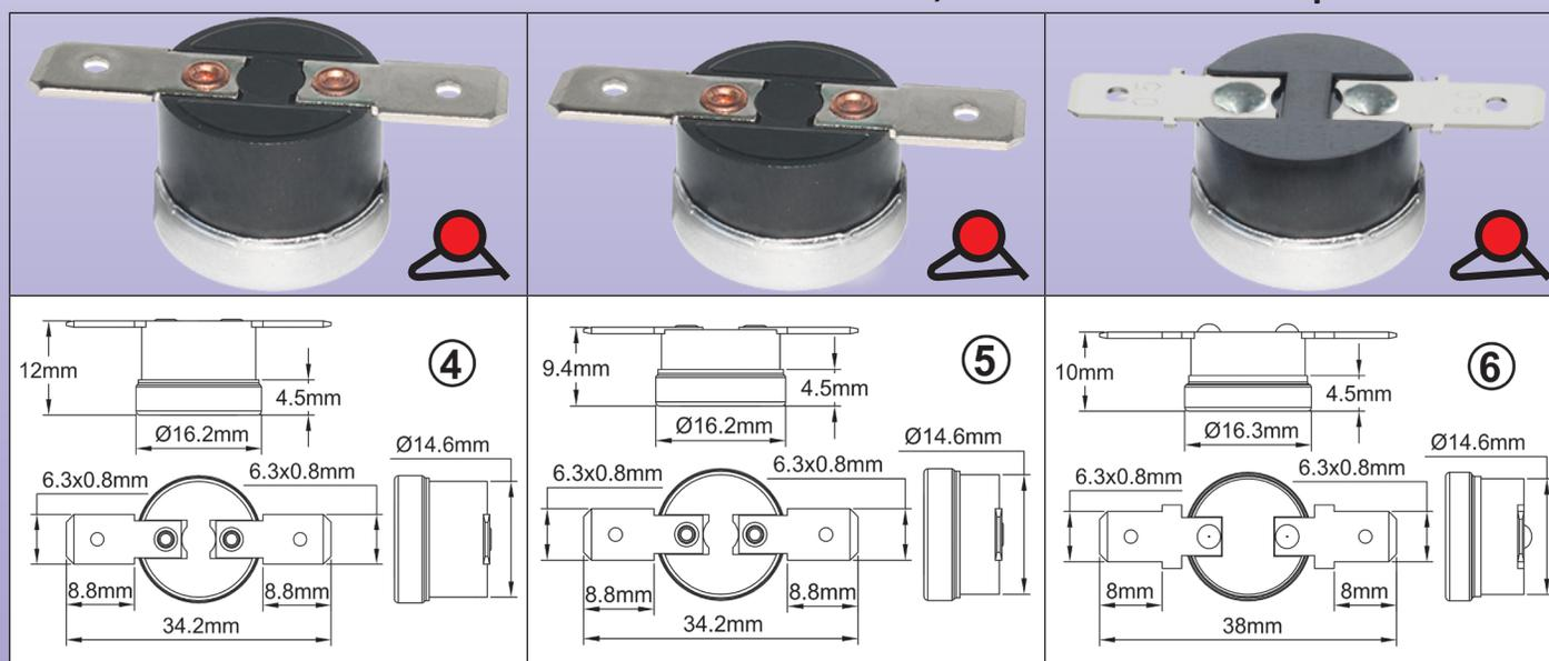
Frostschutz-Thermostat, zur Montage am Heizkabelende unter doppelwandiger Schrumpfhülle, mit waagerechten Flachsteckhülsen 6,3 × 0,8, für Schnellanschlüsse oder Löten. Temperaturfühlerschale aus Aluminium. Kontakt öffnet bei Temperaturanstieg.
