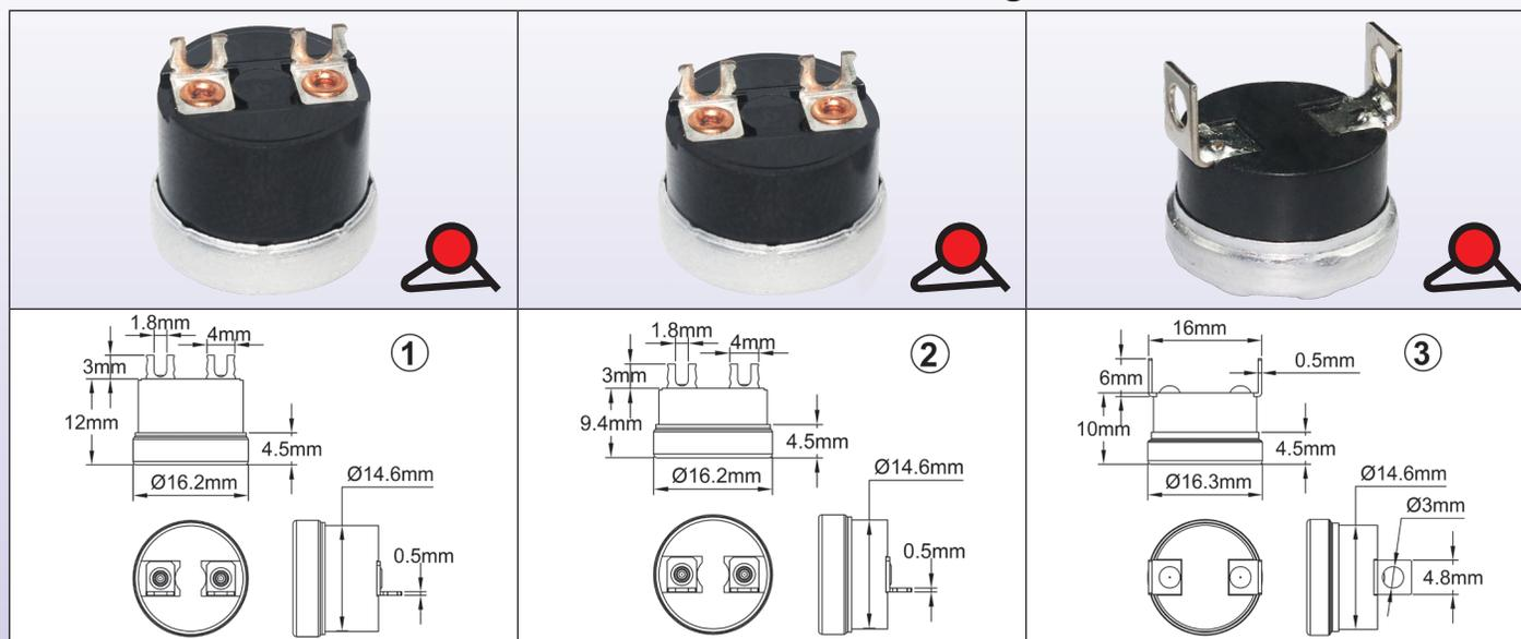
Dieser Scheibenthermostat ist für die Montage am Kabelende geeignet, mit kleinen Lötkekmen und Aluminiumbecher. Er verträgt Silicon- oder Epoxidfüllung. Der Thermostat öffnet sich bei Temperaturanstieg.
