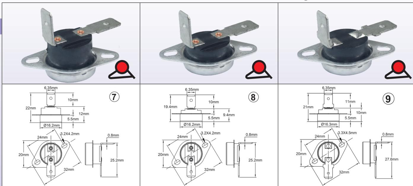
**Frostschutz-Thermostat, für Durch-Wand-Montage auf Abzweig- oder Anschlussdosen, 6,3 × 0,8 Flachklemmen.** Temperaturfühler aus Aluminium mit erweitertem Becher. Der Kontakt öffnet sich bei Temperaturanstieg. Der temperaturfühlende Teil des Thermostats befindet sich außerhalb der Dose, der elektrische Anschluss bleibt im Inneren. Lochbohrung: Ø16,4mm.
